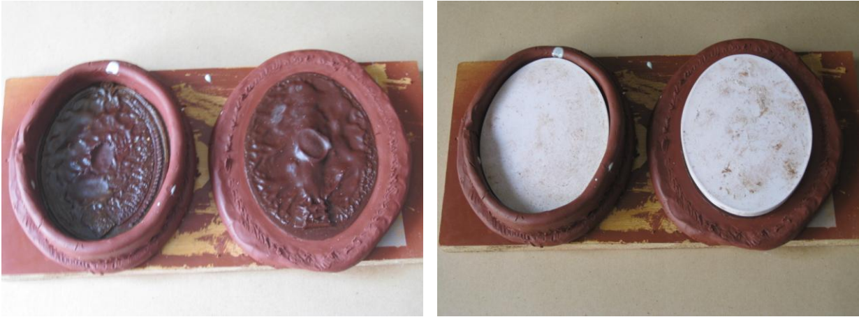
ภาพประกอบ : ต้นแบบกลับทำด้วยเรซิน
