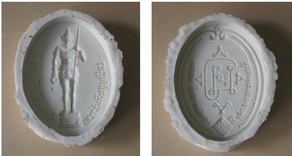
ภาพประกอบ : การถอดแบบด้วยยางซิลิโคน
