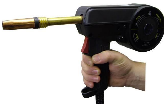
รูปที่ 1-7 แสดงลักษณะหัวเชื่อมแบบดึงลวด
