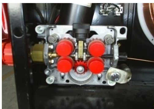
รูปที่ 1-19 แสดงลักษณะล้อป้อนลวดและล้อคัตลวดเชื่อมชนิด 4 ล้อ (ที่มา : สุรียนต์ ฉิ่งแก้ว. 2560)
