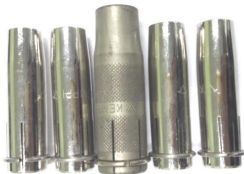
รูปที่ 1-10 แสดงลักษณะหัวฉีดแก๊สงานเชื่อมอาร์กโลหะแก่สคลุม (ที่มา : สุริยนต์ ฉิ่งแก้ว. 2560)
