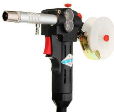
รูปที่ 1-6 แสดงลักษณะหัวเชื่อมแบบระบบป้อนลวดในตัว
