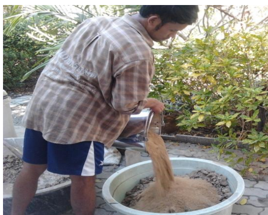
ภาพประกอบที่ 4.10 แสดงการผสมดินและทราย อัตราส่วน ดิน 3 ส่วน : ทราย 1 ส่วน
