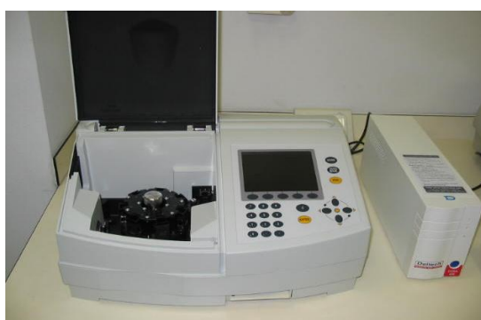
ภาพประกอบที่ 2.34 เครื่องวัดค่าการดูดกลืนแสงแบบลำแสงคู่
