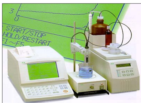
ภาพประกอบที่ 2.39 เครื่องไตเตรทอัตโนมัติ
