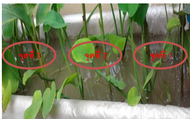
ภาพประกอบที่ 4.27 แสดงตำแหน่งจุดเก็บน้ำตัวอย่างหลังการบำบัด ของบ่อดูดที่มีพืช
