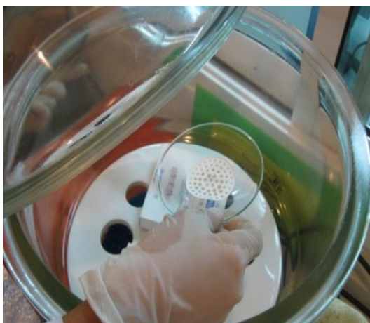
ภาพประกอบที่ 4.36 แสดงการนำกระดาษกรองเข้าโถดูดความชื้น
