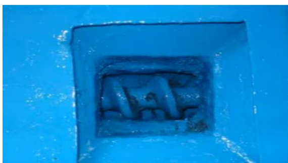
ภาพประกอบที่ 4.6 เกลียวเครื่องอัดแท่งเชื้อเพลิง
