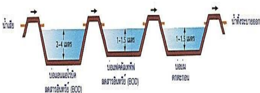
ภาพประกอบที่ 2.5 การวางบ่อของระบบบ่อปรับเสถียร (Stabilization Pond)
